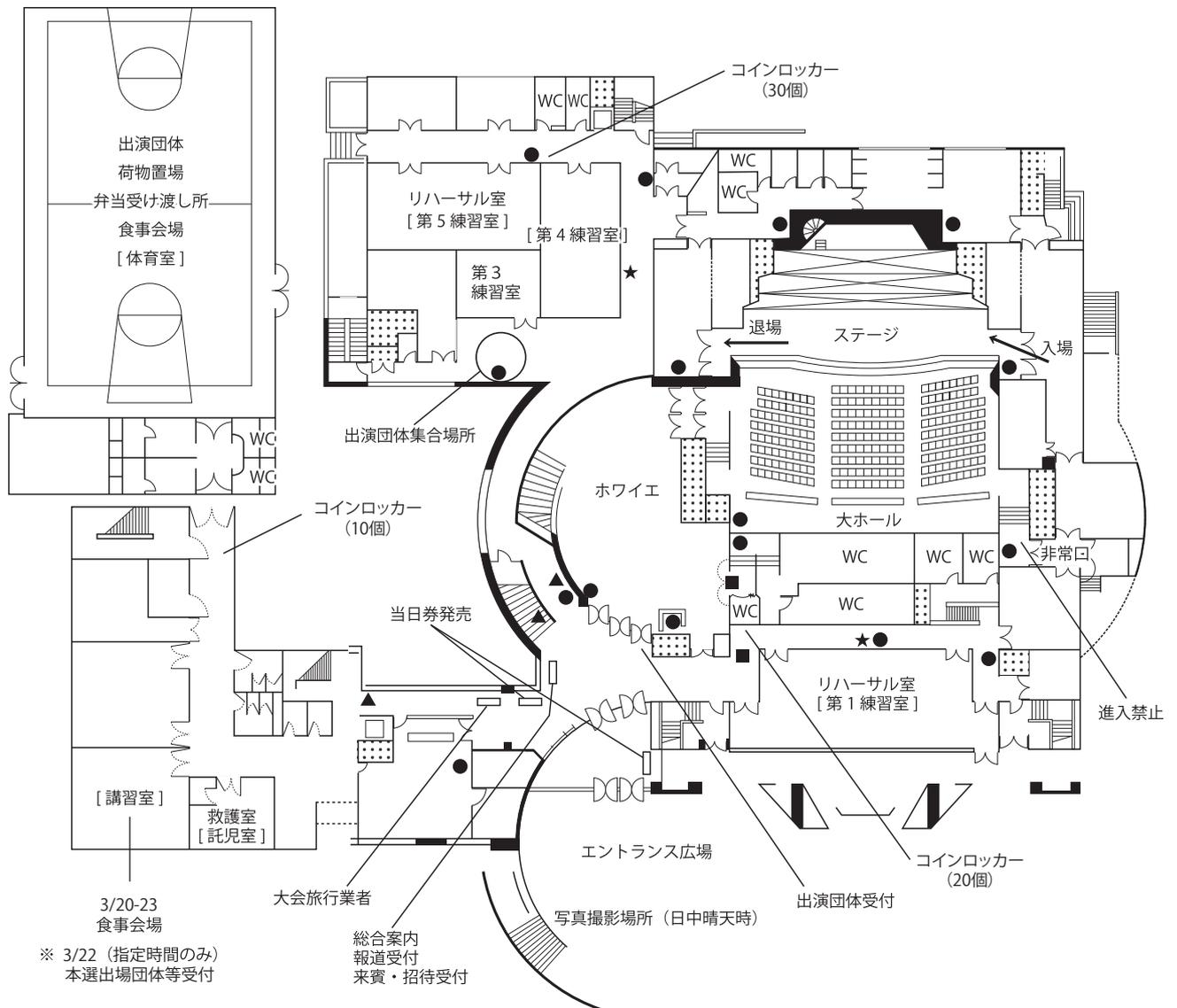
●消火器 ★消火柱 ▲防火シャッター手動閉鎖装置 ■防火扉
